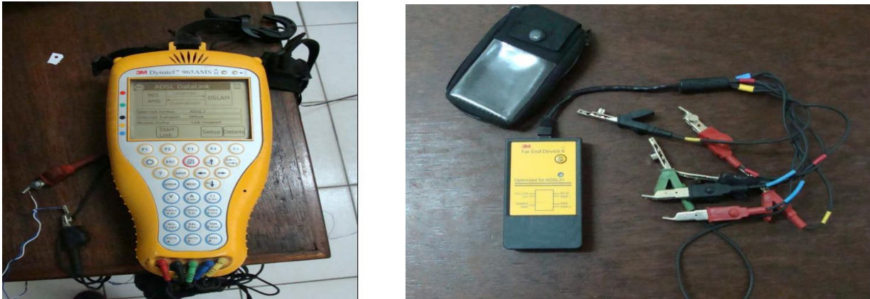
Figuur 10. 3M dynatel 965AMS en de FAR End Device
